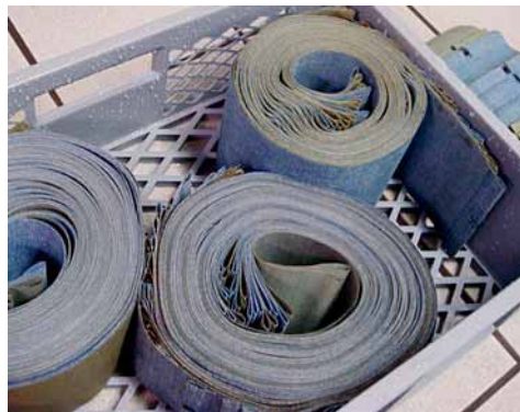
Gereinigte Lamellen nach dem Waschvorgang.
