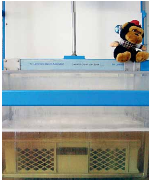
Hubmechanisches Waschverfahren: Lamellen in der Vorwäsche.
